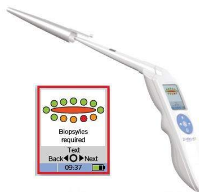
Figura 1: Foto da sonda ZedScan, mostrando os 12 pontos de coleta com o mapa de cores associado.
