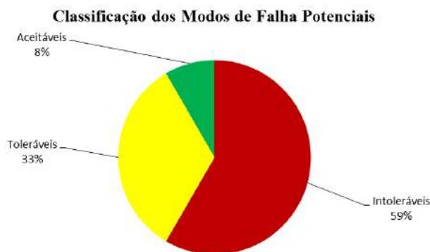
Figura 5: Gráfico de classificação dos modos de falha e suas causas potenciais de acordo com a Matriz de Pontuação de Risco.
