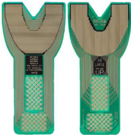
Figura 1: TSCAN®: matriz de sensores FSR, vistas inferior e superior, da esquerda para a direita, respectivamente.
