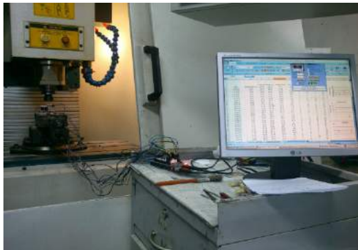
Figura 5: Sistema montado no centro de usinagem para a captação de dados dos ensaios de furação.
