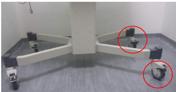
Figura 3: sistema de travas danificados ou não acionados
