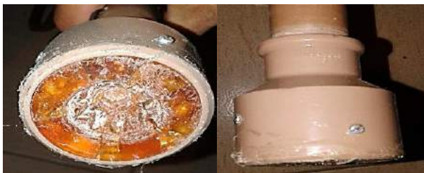
Figura 5: Bucha de resina desenvolvida para acoplar a conexão de PVC à engrenagem do motor DC.
