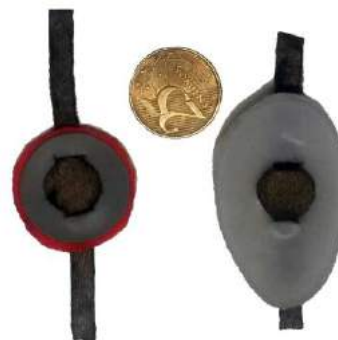
Figura 3: Sobreposição dos eletrodos eTêxtil com silicone de aderência utilizado em roupas fitness. O da esquerda o Tipo 1 e o da direita o Tipo 2.
