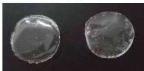
Figura 3: Filmes produzidos a partir de Celvol® 205 à esquerda e de Celvol® 523 à direita.
