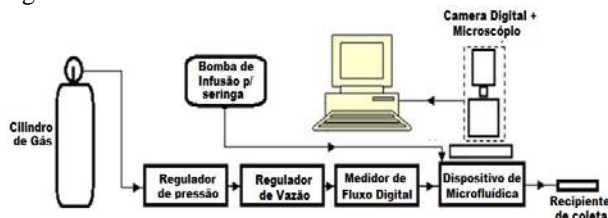
Figura 4 - Diagrama esquemático dos equipamentos utilizados na geração de microbolhas.
