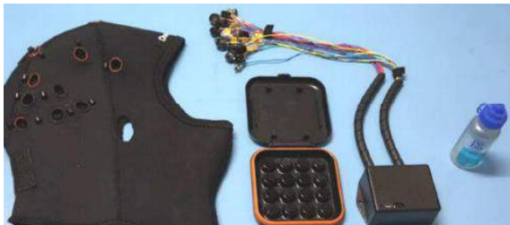
Figura 1: Touca desenvolvida para a captura dos sinais de EEG
