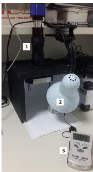
Figura 1: Montagem experimental indicando o conjunto câmera/lente acoplado à caixa metálica (1), a luminária (2) e o luxímetro digital (3).
