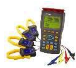
Figura 2: Analisador de Energia Elétrica Digital Trifásico, Marca Homis.
