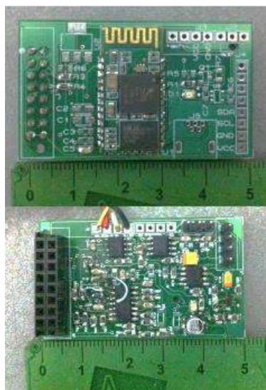
Figura 2 - Placa de aquisição com módulo Bluetooth integrado (placa superior) e placa amplificadora do sinal (placa inferior).
