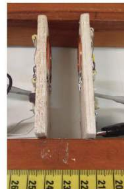
Figura 3. a) Loops com aproximadamente 30 mm de diâmetro e fio 0,91 mm de diâmetro (conforme esquema proposto na Figura 2). b) Sistema de medição com gerador de função e osciloscópio. c) Distância de 2 cm, correspondente a máxima transferência de potência (ver Figura 4).
