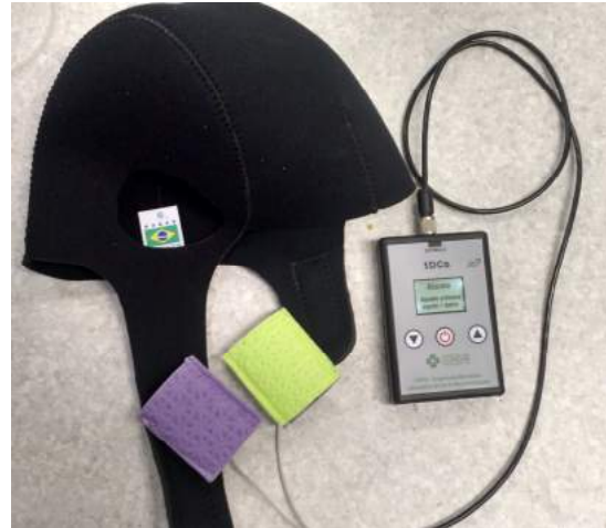
Figura 5 – Protótipo do equipamento de ETCC desenvolvido.
