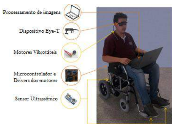
Figura 1: Protótipo do sistema desenvolvido. Cadeira de rodas motorizada controlada pelo rastreamento do movimento da pupila do usuário.
