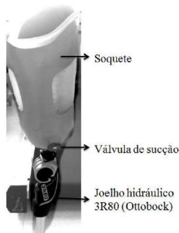
Figura 2. Modelo da prótese de membro inferior com identificação de seus componentes. Fonte: Arquivo próprio.
