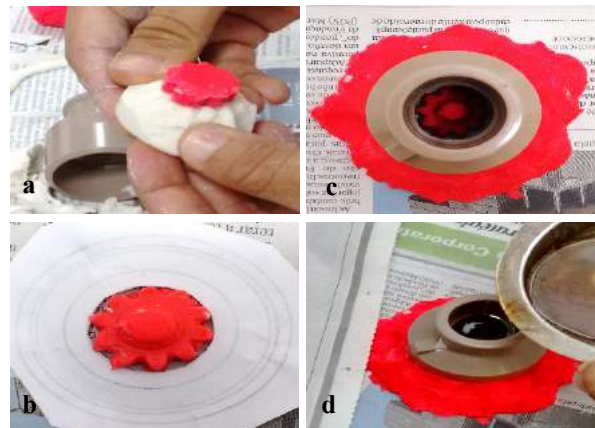
Figura 3: Confeção de uma bucha de resina para acoplar a engrenagem do motor à conexão de PVC do dispositivo.
