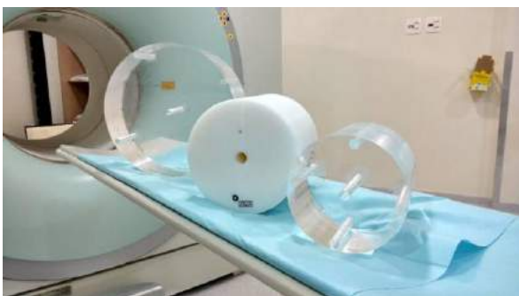
Figura 1: Simuladores utilizados na aquisição de dados de PET. Da esquerda para a direita: simulador de PMMA de 32 cm de diâmetro; simulador de PEAD de 20 cm de diâmetro; simulador de PMMA de 16 cm de diâmetro.
