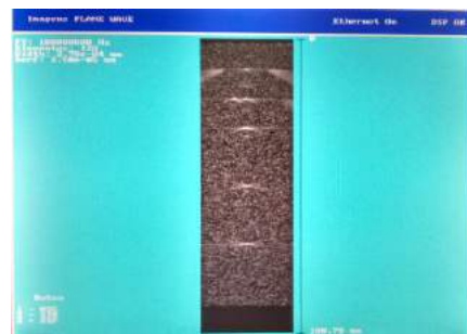
Figura 7: Imagem processada pelo sistema excitando-se os 128 elementos com disparo único.
