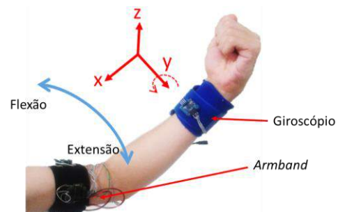
Figura 2: Sistema armband e giroscópio com indicação de seus eixos e direção dos movimentos de flexão e extensão.
