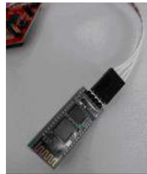
Figura 2: Módulo bluetooth EGBT-046S da e-Gizmo [7].
