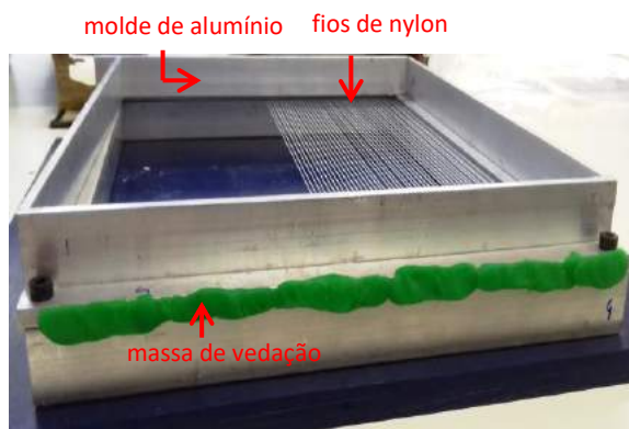
Figura 1: molde de alumínio contendo fios de nylon.
