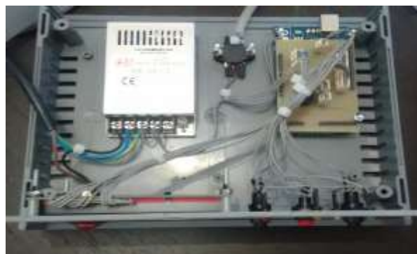
Figura 3. Distribuição do circuito eletrônico utilizado para construção do dispositivo.
