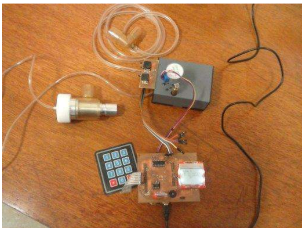
Figura 4: Visão geral do sistema, com a válvula de dreno à esquerda, a válvula de agulha com o motor e os sensores de pressão na parte de cima, e o sistema eletrônico na parte de baixo.
