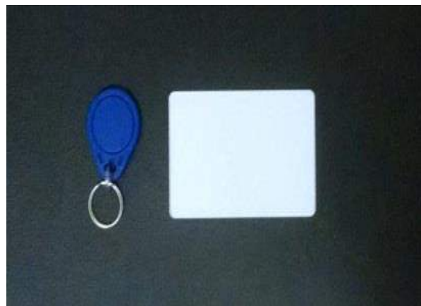
Figura 2: Tags passivas utilizadas no trabalho.
