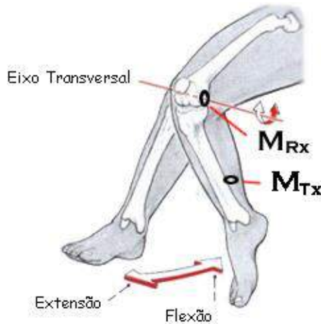
Figura 2: Disposição das bobinas transmissora e receptora para a medição do ângulo da articulação do joelho. Figura adaptada de Sabotta [7].
