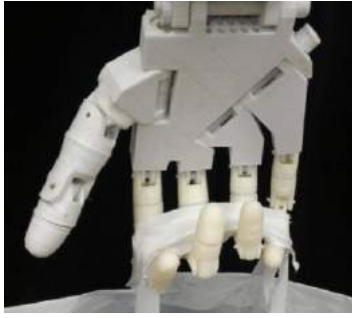
Figura 3 - Distribuição desigual da tensão da carga sobre os dedos da prótese.
