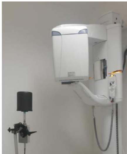
Figura 2: Câmara de ionização posicionada a 50 cm e 45° do centro do equipamento.
