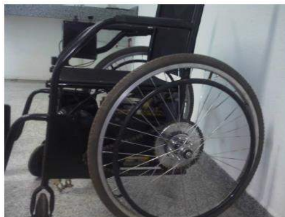
Figura 5: Sistema de Transmissão da Cadeira de Rodas Automatizada.
