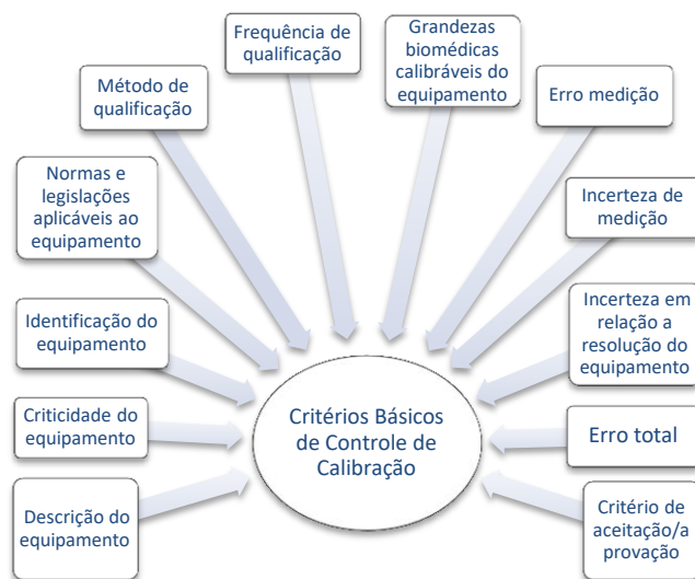
Figura 2- propostos íçam adicional de critérios básicos de controle de calibração dos equipamentos biomédicos.
