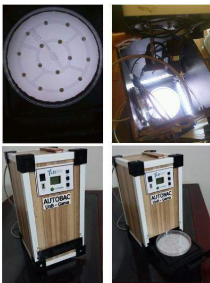
Figura 1: Protótipo funcional construído. Superior esquerdo: imagem adquirida com iluminação difusa; Superior direito: visão interna do protótipo ilustrando as iluminações laterais e na base da placa; Inferior esquerdo: protótipo com gaveta fechada; Inferior direito: protótipo com gaveta aberta e placa inserida.
