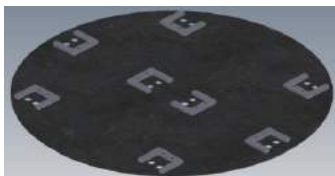
Figura 1 - Disposição das células de carga para soldagem.
