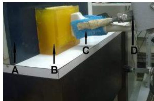
Figura 4: Montagem experimental com transdutor em posição vertical. Placa absorvedora de US (A) junto ao phantom de parede torácica (B), e transdutor do ultrassonógrafo em posição vertical (C) fixado por uma morsa articulada (D).
