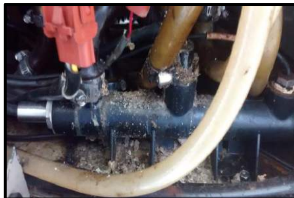
Figura 1: Foto da região interna da primeira PA com partes metálicas oxidadas logo a baixo dos tanques dos químicos.
