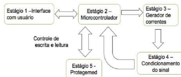
Figura 2 : Diagrama em blocos do circuito proposto
