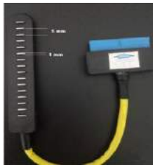
Figura 1: Arranjo linear de 16 eletrodos (OT Bioelettronica, Torino, Itália) usado como modelo para confecção do eletrodo proposto.
