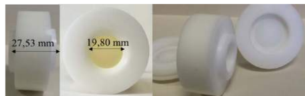
Figura 1: Fotografia do porta amostra. (a) parede lateral com 27,53 mm de comprimento; (b) face com janela de 19,80 mm de diâmetro; (c) conjunto com as tampas.
