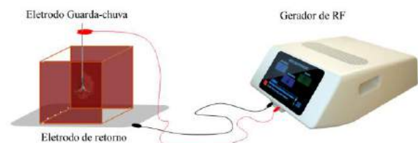
Figura 1. Diagrama ilustrativo do funcionamento do equipamento de ablação hepática. Da direita para esquerda: equipamento de ablação hepática, eletrodo de retorno e eletrodo guarda-chuva ativo em uma peça de fígado ( ex-vivo ). *Figura atualizada
