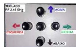
Figura 2: Teclado sem fio de anotação dos comandos com 5 teclas, sendo 4 direcionais (esquerda, direita, acima e abaixo) e uma central (não utilizada no protocolo experimental).
