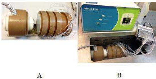
Figura 3: A) Transdutor acoplado à superfície do phantom no calorímetro, B) Montagem experimental no interior do banho termostático, contendo calorímetro, transdutor e aparelho de aquisição de sinais fora do banho.
