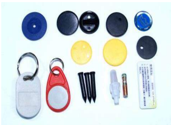
Figura 1: Diferentes tipos de tags NFC [5].
