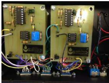
Figura 4: Protótipo do circuito projetado, montado em placa de circuito impresso a fim de evitar interferências por ruídos ambientais.
