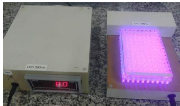
Figura 5: Matriz de leds montada num formato de 10 linhas e 14 colunas com a sua fonte elétrica e horímetro para controle das horas de uso.
