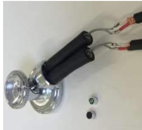
Figura 7: Estetoscópio mecânico de dois tubos com os microfones de eletreto acoplados no interior dos tubos. Detalhe do microfone de eletreto de 6 mm.
