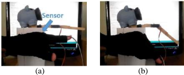
Figura 9: Movimentos do sensor (luva) e do dispositivo eletromecânico (haste) para ângulo 0^{\circ} (a) e 45^{\circ} (b).
