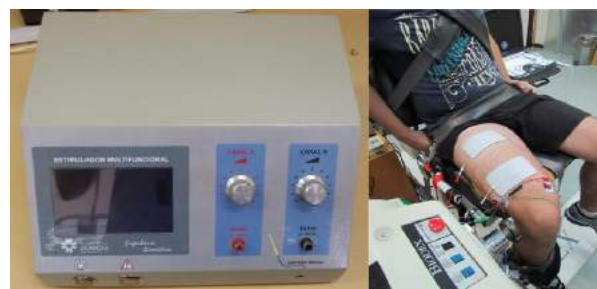
Figura 4: Equipamento desenvolvido e ensaio em sujeito saudável.
