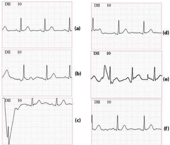
Figura 4: ECG na derivação II para o eletrodo de Silicone E.S. Flex na configuração quadrado (a) 4x4cm sem sobreposição da esponja abrasiva em repouso, (b) sem sobreposição da esponja abrasiva em movimento (c) com sobreposição da esponja em movimento, (d) 2,5x2,5cm sem sobreposição em repouso, (e) sem sobreposição da esponja em movimento e (f) com sobreposição em movimento.
