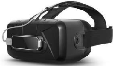
Figura 1: Hardware utilizado na simulação da realidade virtual. É possível visualizar os óculos rift acoplado ao leap motion (Extraído de http://simulatortrends.com/leap-motion-oculus-vr-frustrations-future/ ).
