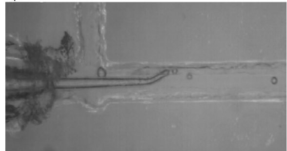
Figura 5 - Dispositivo de microfluídica com micropipeta de diâmetro interno de 70 \mu\text{m} .
