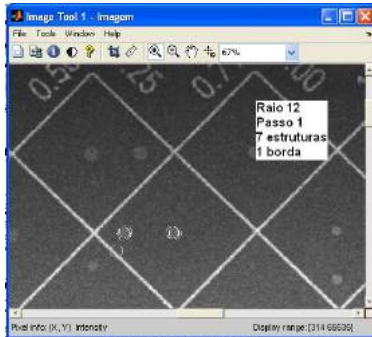
Figura 8. Resultado da detecção dos discos para de espessura 0,5µm e diâmetro 1,0mm, verificando-se a detecção de uma das bordas da matriz.
