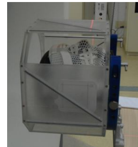
Figura 4: Caixa de localização para radiocirurgia fixada na base estereotáxica, utilizada pelo sistema de planejamento para obter as coordenadas da localização do volume de tratamento.
