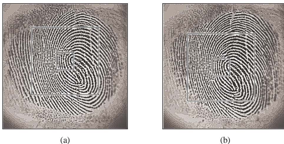
Figura 3.10 - Segmentação por máxima correlação: (a) primeira imagem de uma classe de impressões digitais, segmentada por morfologia matemática, com as regiões de interesse e de referência assinaladas; (b) outra imagem da mesma classe de impressões digitais, segmentada por máxima correlação com a região de referência da primeira imagem, também com as regiões de interesse e de referência assinaladas.
