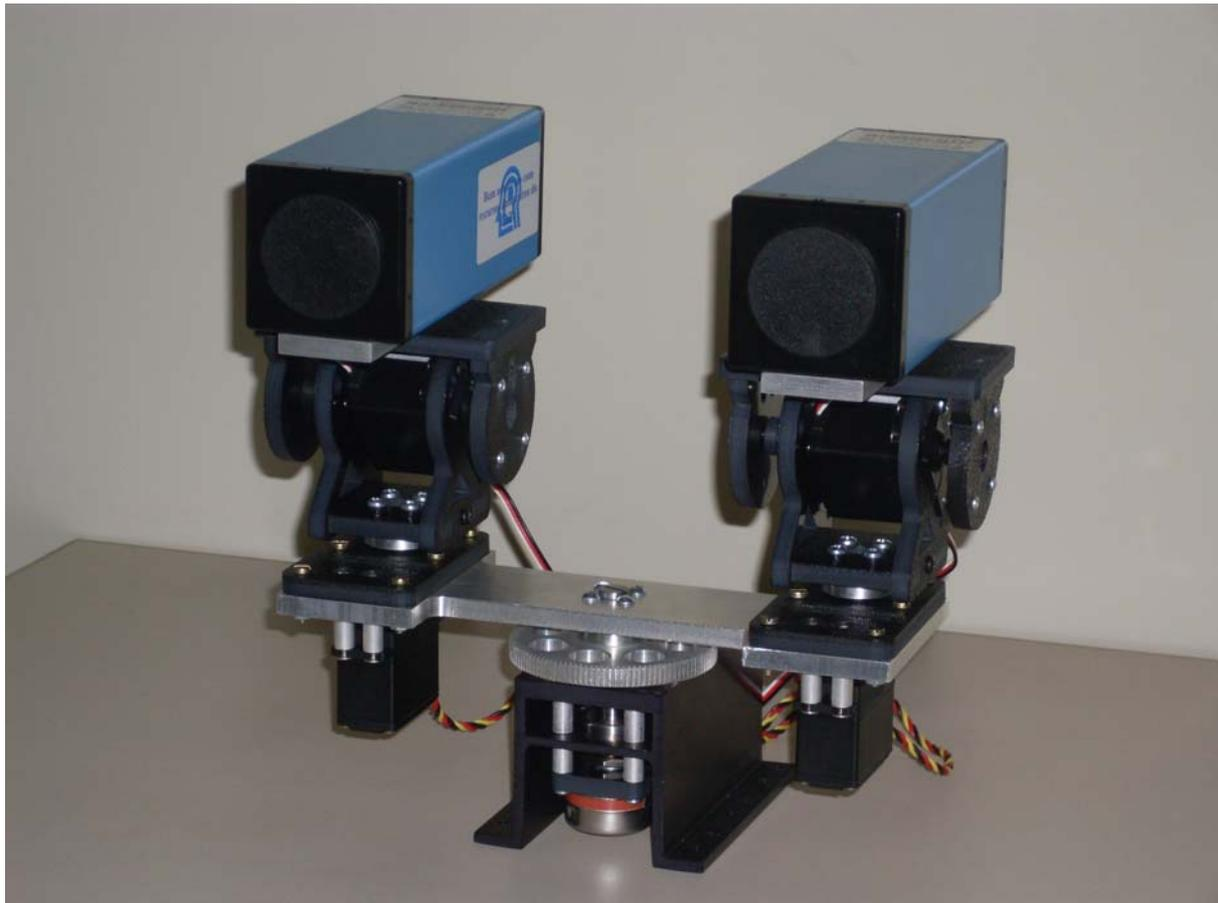
Figura 4 – Protótipo da plataforma robótica com visão estéreo
