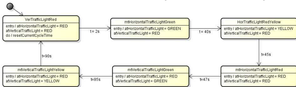
Figura 4. Diagrama de estados para controle independente.
