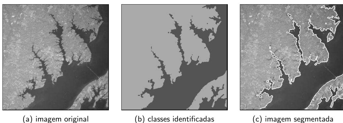
Figura 4.8: Imagem de Baía Chesapeake, MA, Anápolis, USA . Segmentação inicial e final utilizando a transformada wavelet de Daubechies. Imagem composta de 320 \times 320 pixels.
