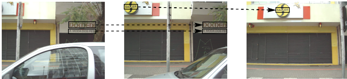
Figura 3: Saída de um algoritmo de rastreamento de texto: regiões de texto detectadas (retângulos) e a informação de rastreamento (setas).
